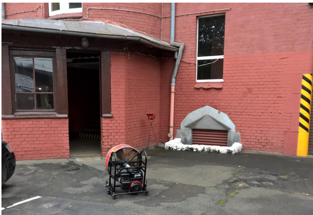
Rys. 9 – Typowy przenośny wentylatory osiowy będący na wyposażeniu jednostek PSP umożliwiający zwiększenie skuteczności usuwania dymu z klatki schodowej (fot. MN)
